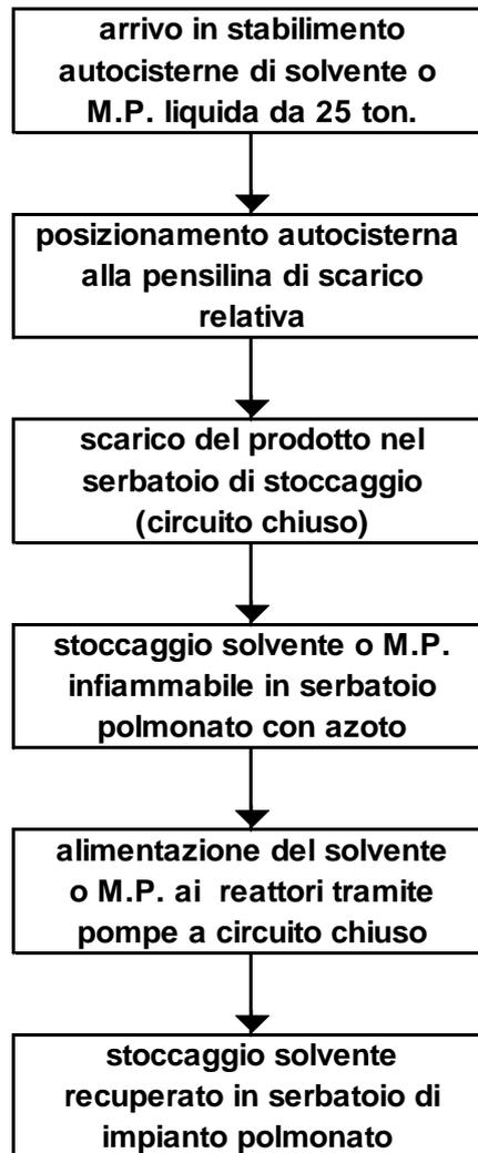
Le autocisterne cariche di prodotti infiammabili arrivano in stabilimento polmonate con azoto. I serbatoi di stoccaggio da 30 a 60 mc sono polmonati con azoto ed eserciti a temperatura ambiente ed ad una pressione di 0,0002 bar. Il trasferimento interno avviene a temperatura ambiente tramite pompe con pressione max. di 3 kg/cmq.
